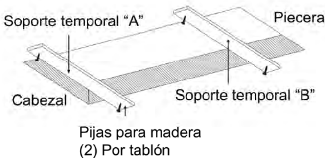
FIGURA 8 : INSTALACIÓN DE SOPORTES TEMPORALES
